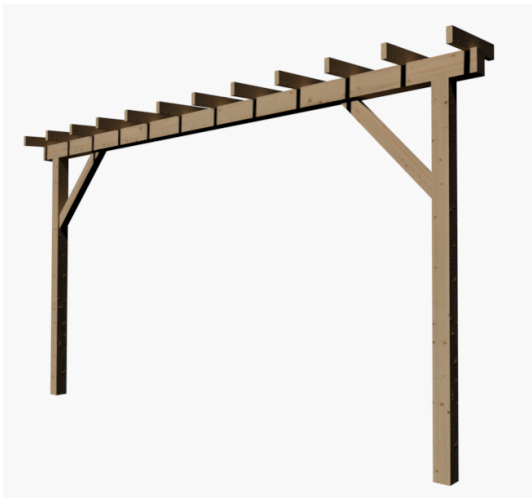
p.19 Brána pro popínavou rostlinu Konstrukce z dřevěného hraněného dřeva, impregnované . Sloupky mají kotevní patku s hrotem a objímkou, žárově zinkovaná ocel.
